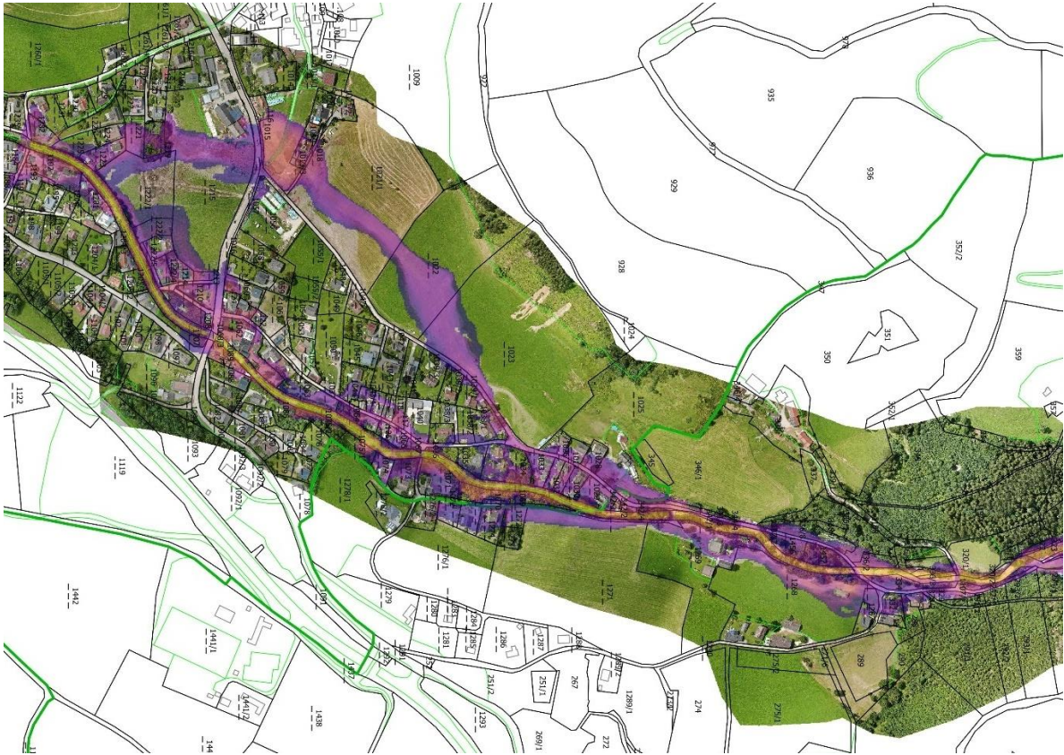
Abbildung 81: Ergebnis der Flo-2D Simulation Feistringbach: Q = 60 \text{ m}^3/\text{s} , Brücken verkleust, Anlaufzeit 1 h, Simulationsdauer 2 h.
