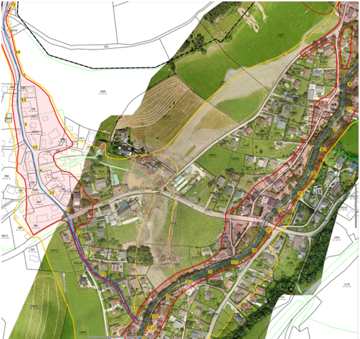
Abbildung 80: Detail aus der Überlagerung des aktuellen Gefahrenzonenplans der Gemeinde Aflenz mit Luftbildern des Ereignisses vom 17. Juli.
